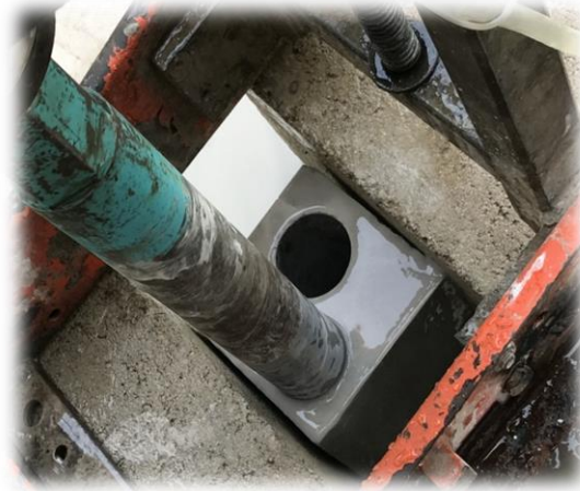
شكل (4) استخراج العينات بواسطة جهاز القلب الخرساني
