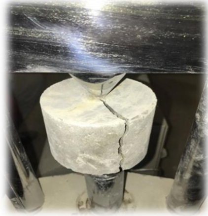
شكل (6) شكل انهيار عينة الخرسانة في اختبار تحميل النقطة
